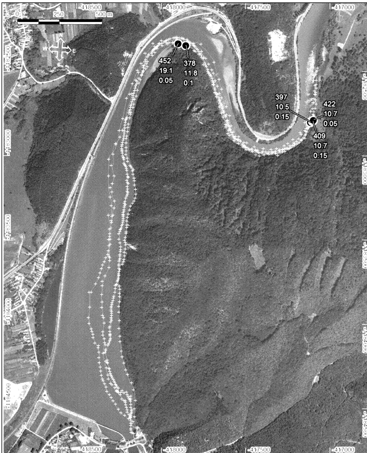
Obr. 5.13. Miesta termometrických a rezistivimetrických meraní na krpelianskej vodnej nádrži (biele krížiky) a zdokumentované pramene a prítoky (čierny krúžky s hodnotami vodivosti [ \mu\text{S} \cdot \text{cm}^{-1} ], teploty [ ^{\circ}\text{C} ] a výdatnosti [ \text{l} \cdot \text{s}^{-1} ]) z 26. júna 2005.
